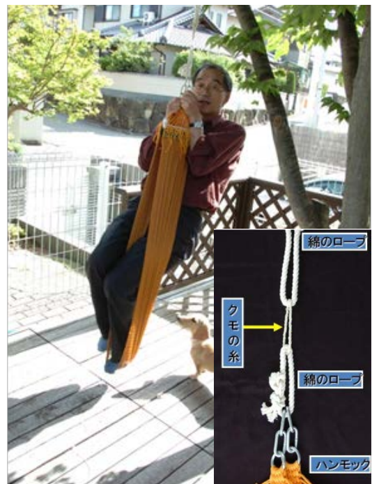
図3 クモの糸束にぶら下がる著者 クモの糸は矢印の細い部分で、木に結んだ綿ロープとハンモックの間に直列に繋がれている。
